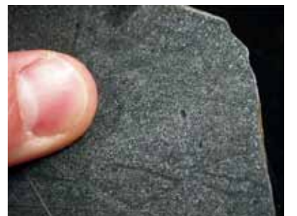
▲ 遠軽橋下の岩石標本（砂岩）。堆積岩は粒子の大きさにより分類されます。0.063 mm以下（シャープペンの芯の直径より小さい）を泥岩、2 mm以下を砂岩、2 mm以上を礫岩として分類します。
